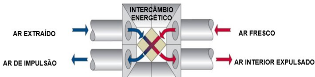
Figura 11. Recuperação de calor
