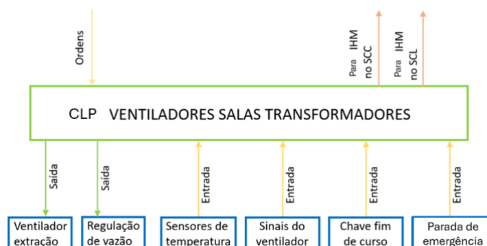
Figura 3. Controle e supervisão ventiladores de extração das salas de transformadores.
