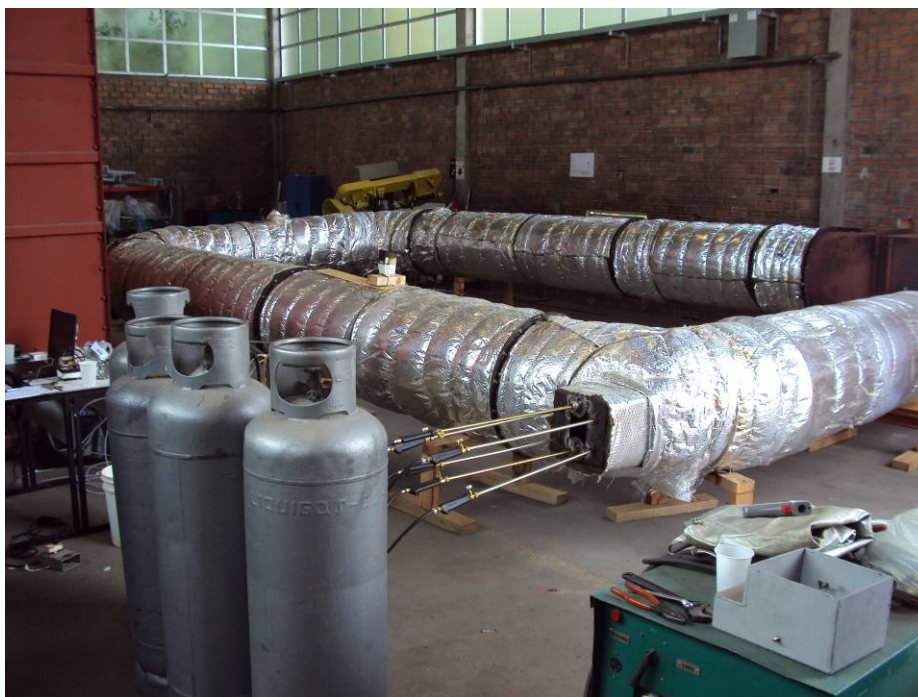
Foto 2 – Foto da montagem da bancada utilizada no ensaio
