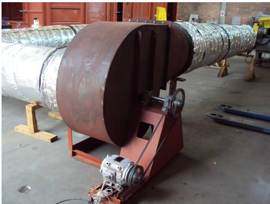
Foto 1 –Ventilador ensaiado montado na bancada de testes do fabricante
